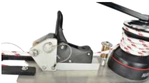
Image E18 Line brake open
