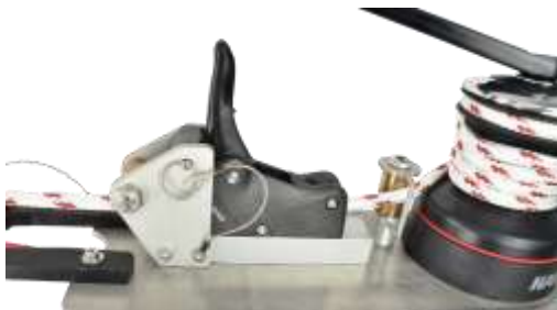
Image E18 Line brake open
